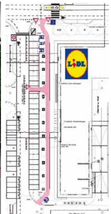
In roze: Nieuw fietspad over trottoir
